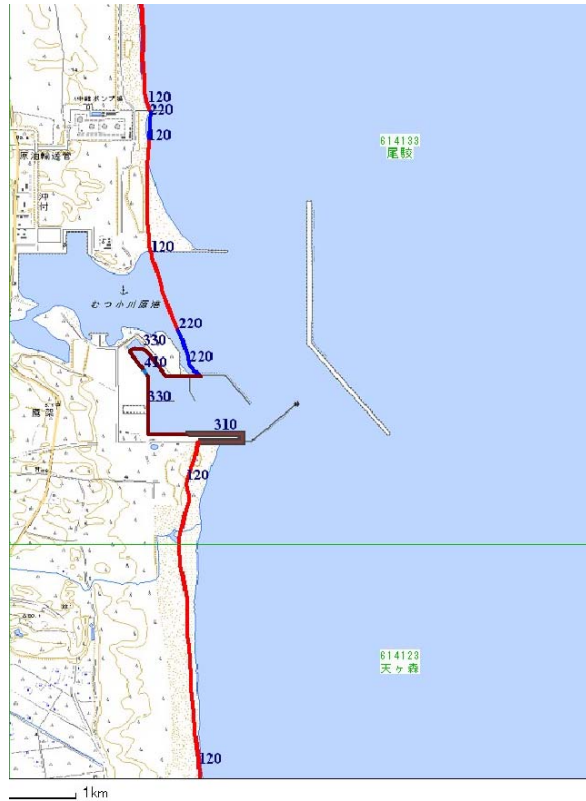
図 2-3-2 青森県六ヶ所村：むつ小川原港建設による人工海岸化
