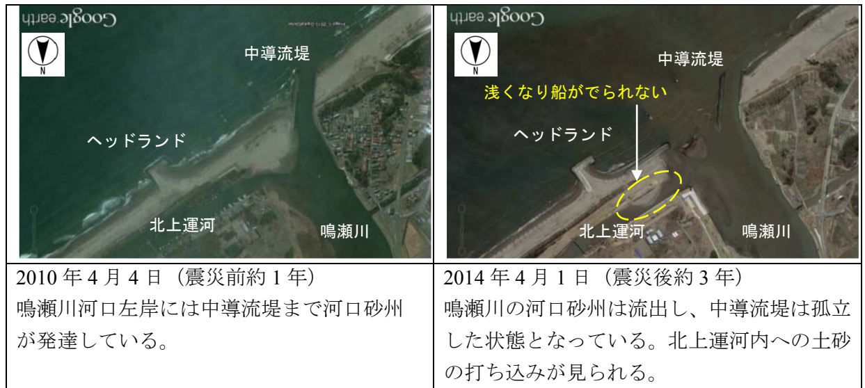
図 5.2-35 鳴瀬川河口左岸の河口砂州の状況
