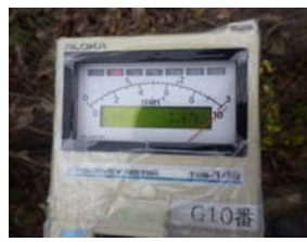
線量測定による安全管理
