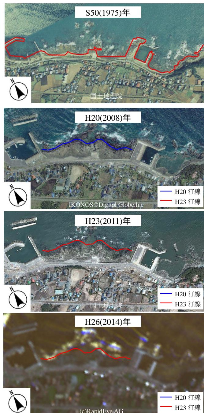
図 2.8 空中写真・衛星画像による海岸の変遷（階上町追越海岸）
