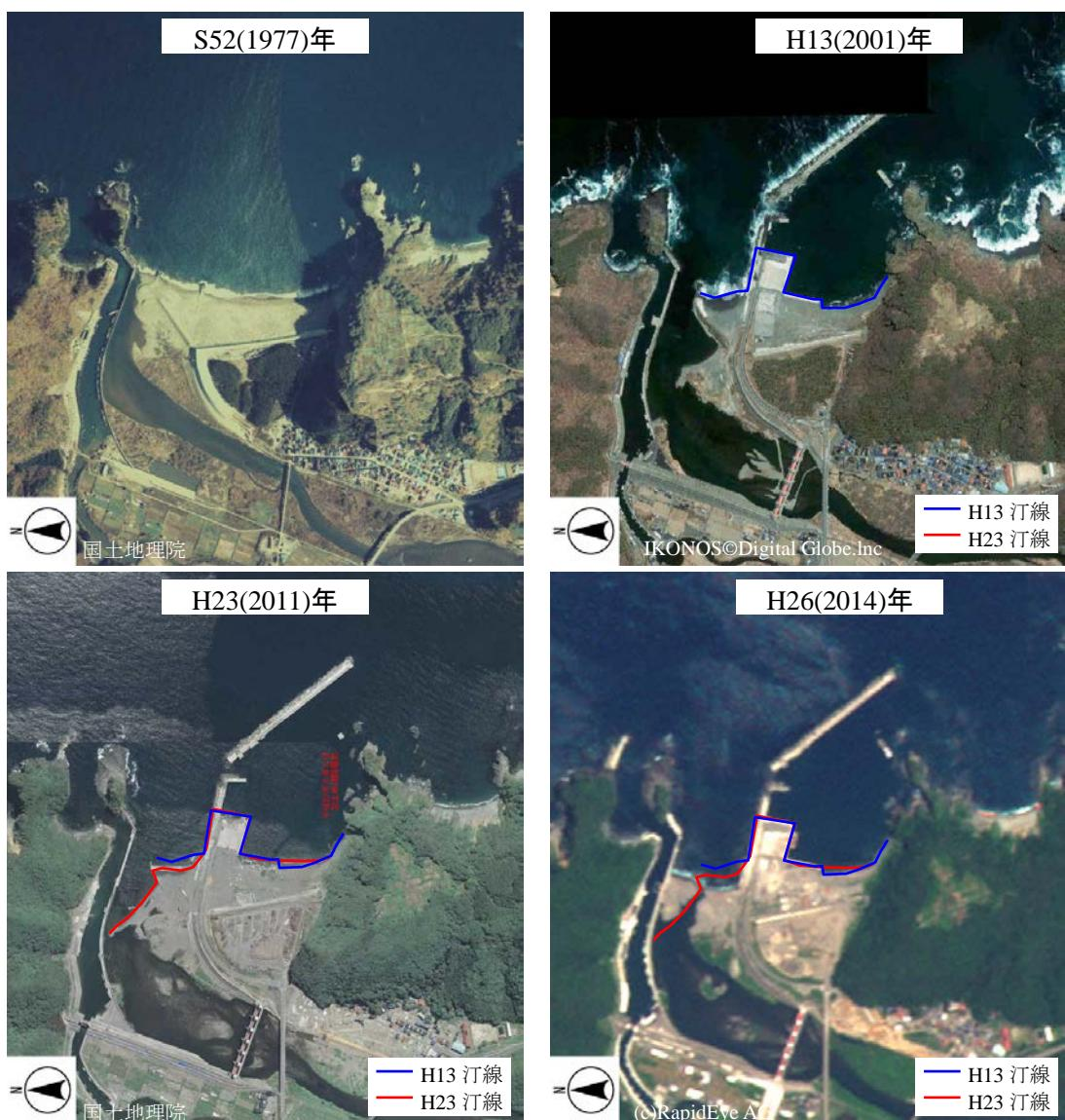
図 2.8 空中写真・衛星画像による海岸の変遷（岩泉町小本港海岸）
