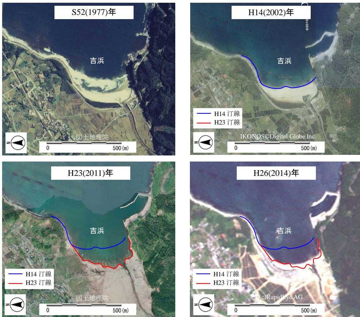
図 2.9 空中写真・衛星画像による海岸の変遷（大船渡市吉浜海岸）
