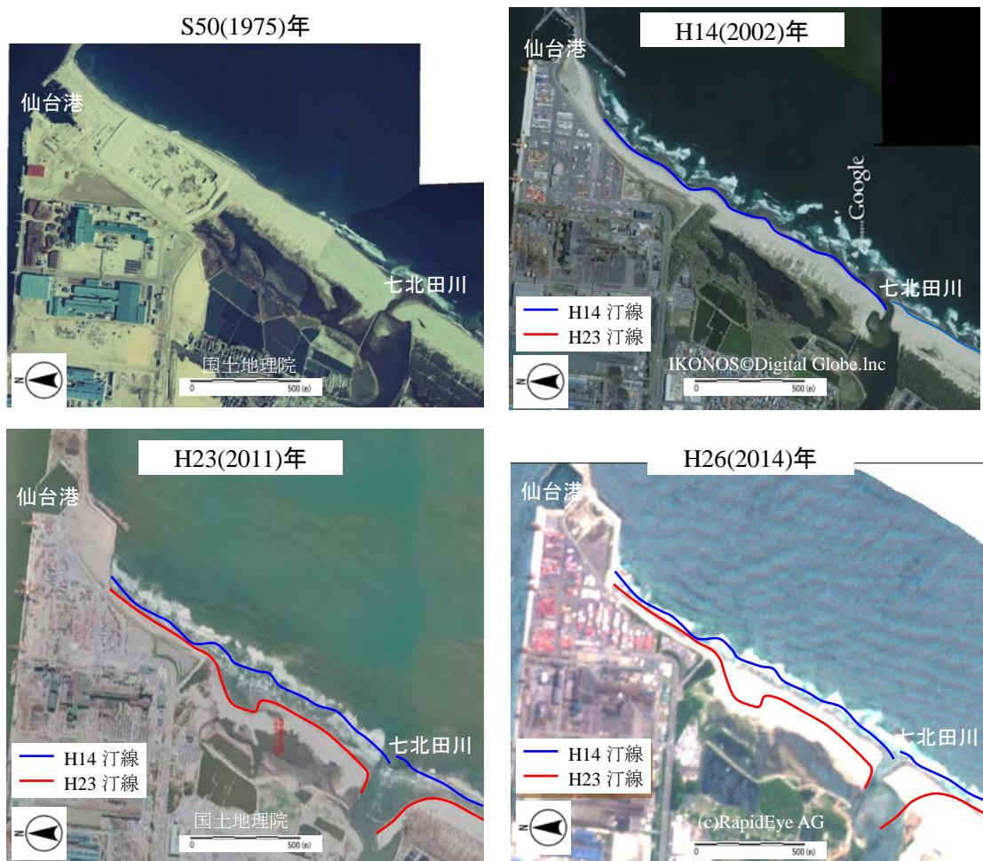
図 2.9 空中写真・衛星画像による海岸の変遷（仙台市蒲生海岸）
