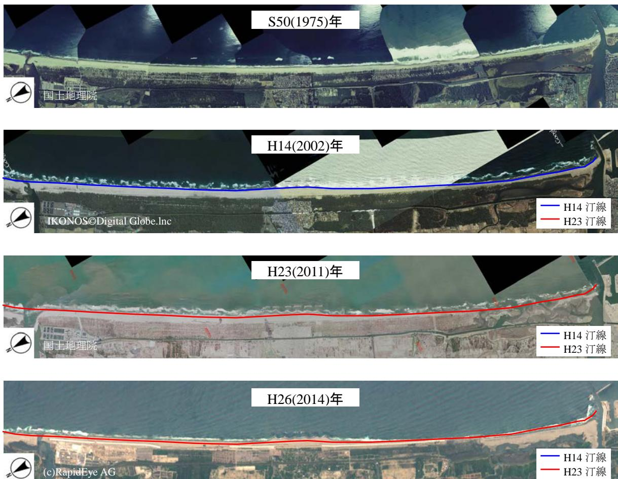
図 2.11 空中写真・衛星画像による海岸の変遷（仙台市荒浜海岸）
