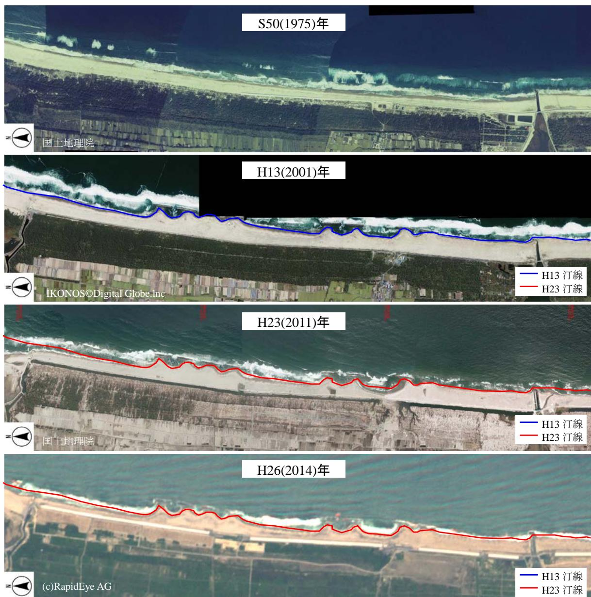
図 2.8 空中写真・衛星画像による海岸の変遷（亘理町吉田海岸）
