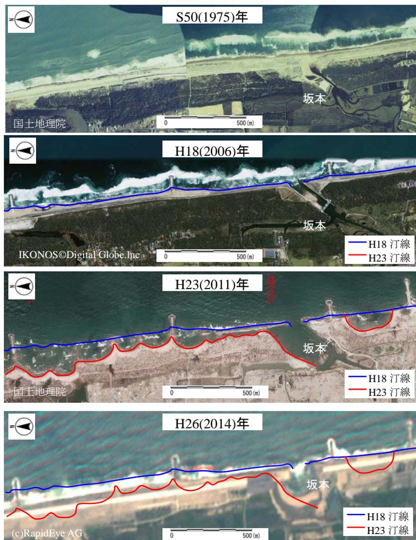
図 2.8 空中写真・衛星画像による海岸の変遷（山元町中浜海岸）
