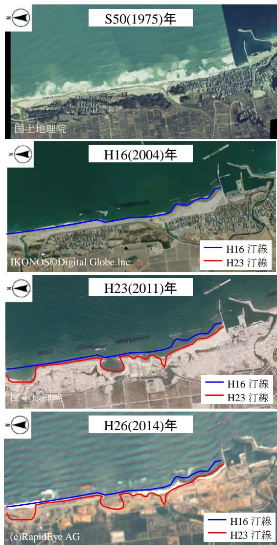
図 2.8 空中写真・衛星画像による海岸の変遷（新地町釣師浜海岸）
