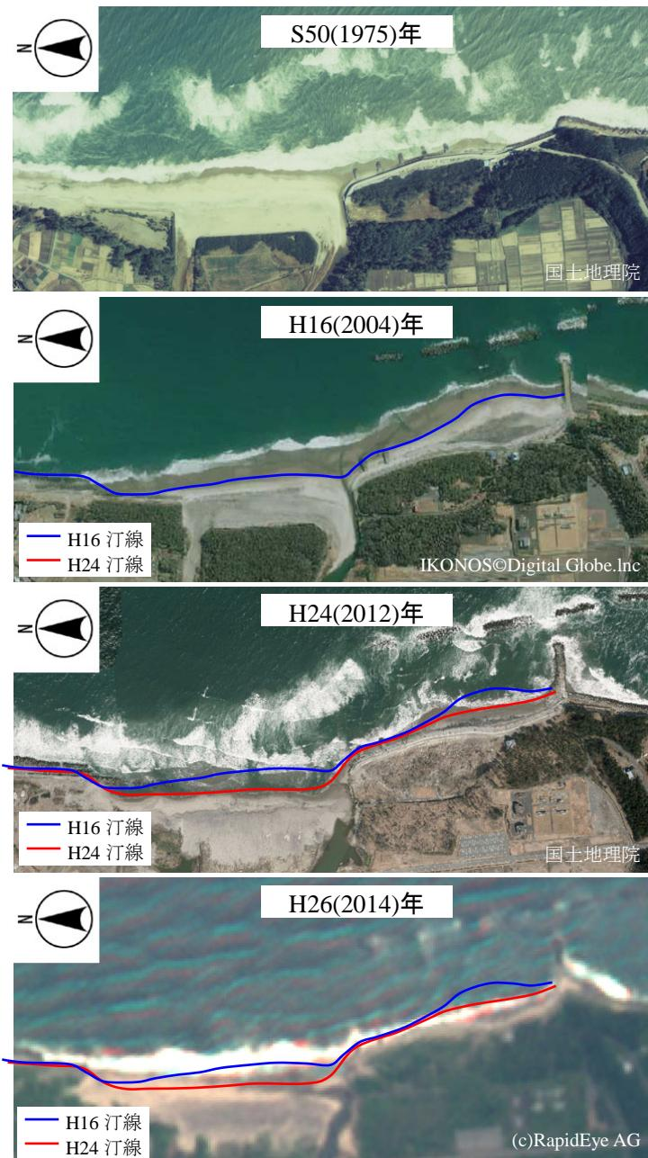
図 2.8 空中写真・衛星画像による海岸の変遷（双葉町郡山中野海岸）
