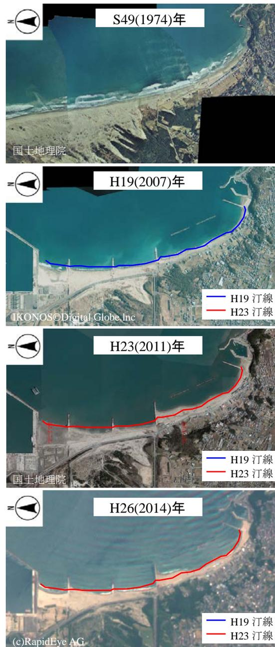
図 2.8 空中写真・衛星画像による海岸の変遷（ひたちなか市阿字ヶ浦海岸）
