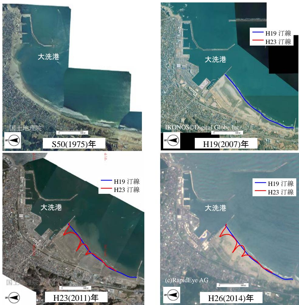
図 2.8 空中写真・衛星画像による海岸の変遷（大洗町大洗海岸）
